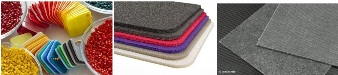
**Les élastomères** (traditionnellement appelés caoutchoucs) sont des matériaux souples, résistants aux chocs, étanches et isolants électriques, pouvant supporter de très grandes déformations avant rupture.
